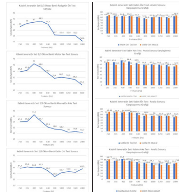
Şekil 23. Kabinli Jeneratör Seti 1/3 Oktav Bantlı Test Sonuçları
